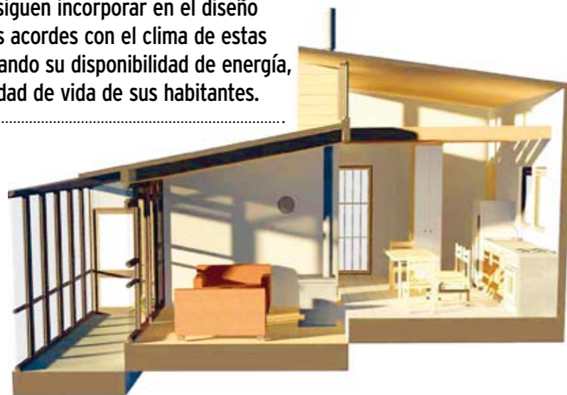
EL INVERNADERO de las viviendas de Puerto Williams ayuda a mantener la temperatura interior.
